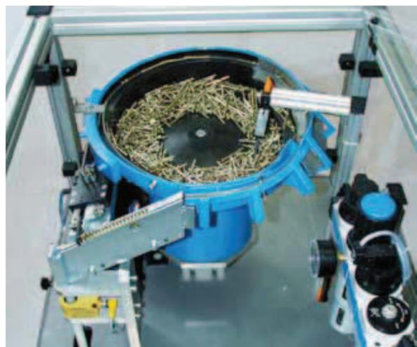
Los remaches se transfieren desde la tolva vibratoria hasta el cabezal de remachado por soplado
