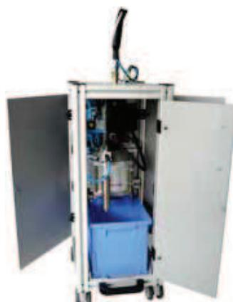
La unidad de suministro contiene un intensificador de presión, válvulas neumáticos y un colector de vástagos.
