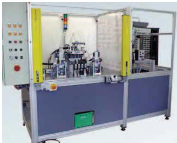
Sistemas de ensamblaje multi-cabezal
